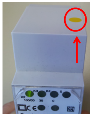
Prüftaste mit Annäherungssensor Auf der Gehäuseoberseite
