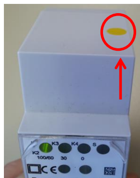
Prüftaste mit Annäherungssensor Auf der Gehäuseoberseite
